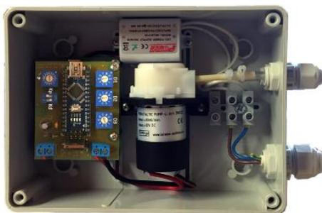
Dosering peristaltisk pump  $U_{in}$  230 V / 50 Hz,  $U_{out}$  12VDC,  $P_{max}$  60W
