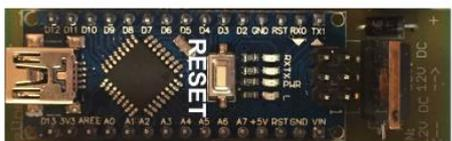
Vid varje ändring av doseringsmängd är det nödvändigt att hålla reset knappen intryckt samt stickkontakten dras ur 4 sekunder. Sätt tillbaka stickkontakten och släpp reset knappen.
